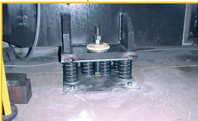
Abkantschere mit Federpaket Typ V1B1136 und Gegenkissen V45
