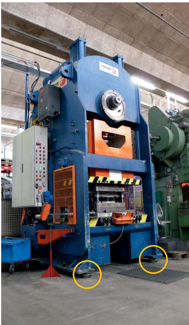
Stanzmaschine auf Vibsol V46W
